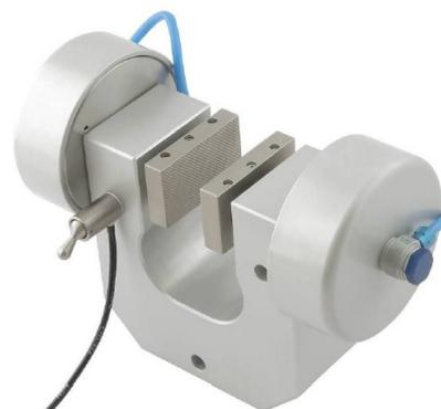
MS240-2,6kN+2Ko+BP mit pneumatischem Mikro-Handschalter
